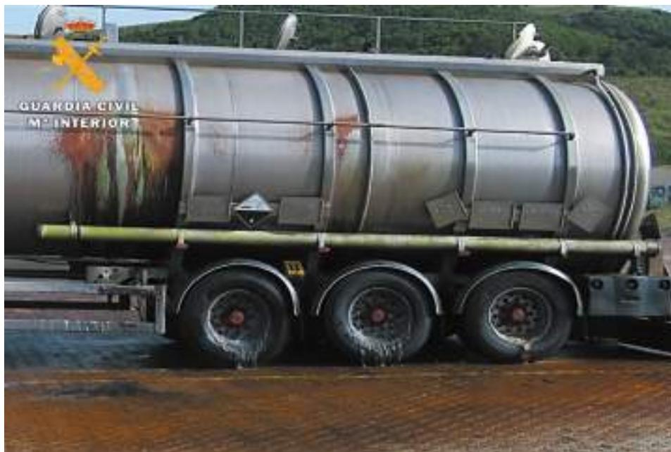
revestimiento interior de los depósitos, que no estaban habilitados para contener dicho producto, provocando su derrame en la autovía AP-1 y posteriormente en un área de servicio de La Bureba, donde el vehículo se detuvo.
